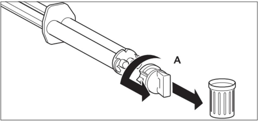
1. 安装混合头前,逆时针旋转90°揭开包装管盖帽[A]或已使用的混合头,丢弃。
