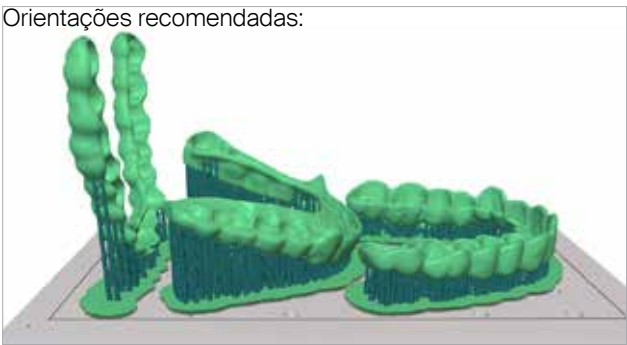
Alinhamento das placas no Rapid Shape Print Studio (da esquerda para a direita: 90°, 20°, 0°)
