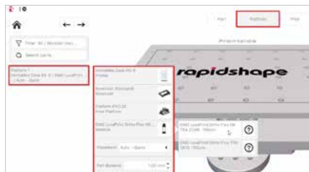
Seleção das configurações da máquina e do material no Rapid Shape Print Studio
