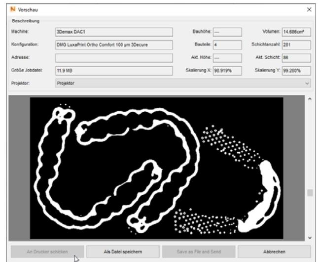
Vorschau des Druckjobs mit Maschinen- und Materialeinstellungen sowie einer Schwarz-Weiß-Darstellung der Druckschichten. Gezeigt ist Schicht 86. Die weißen Bereiche entsprechen der belichteten Fläche der aktuellen Schicht.
