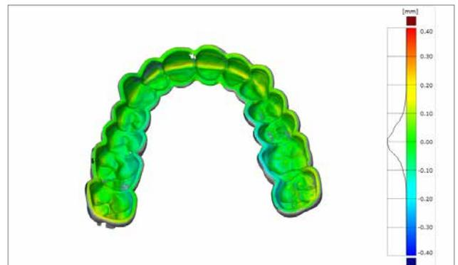
Genauigkeit der Passfläche einer im validierten DentaMile Workflow hergestellten Schiene. Die mittlere Abweichung beträgt 41 µm. Fast die gesamte Passfläche (99,2%) zeigt Abweichungen kleiner als 150 µm.
