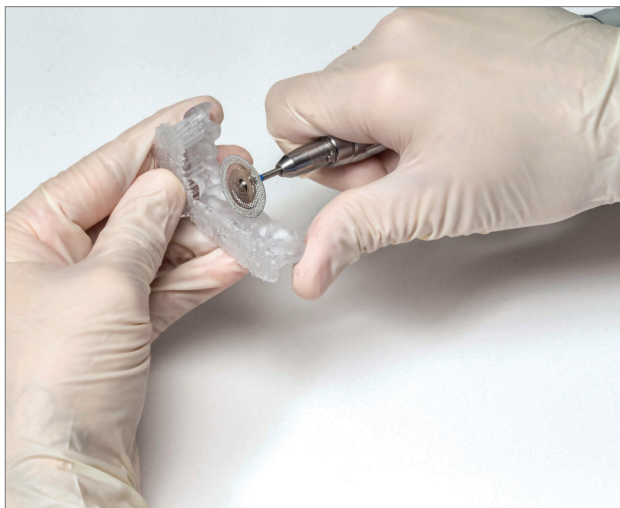
图 22: 使用切割盘移除支撑结构
