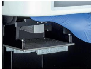
Lösen Sie die Befestigung der Bauplattform.
