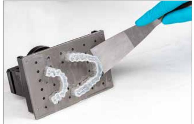
Entfernen der Bleaching-Schienen von der Bauplattform
