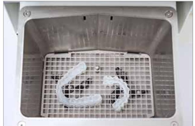
Schienen in der Reinigungseinheit DMG 3Dewash
