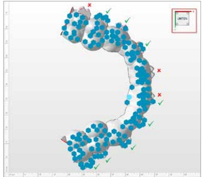
Fehlende Supports (rote Kreuze) und korrekte Supports (grüne Haken) im Bereich der Bracket-Taschen einer Bracket-Transferschiene
