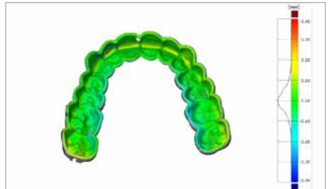
Flächenvergleich der Passfläche einer mit validierten DMG DentaMile Workflow hergestellten Brackettransferschiene im Vergleich mit den digitalen Ausgangsdaten. 99,5 % der Datenpunkte liegen innerhalb einer Toleranz von 150  $\mu\text{m}$ . Die mittlere Abweichung beträgt 43  $\mu\text{m}$ .
