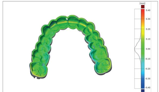
Flächenvergleich der Passfläche einer im validierten DentaMile Workflow hergestellten dentalen Schiene im Vergleich mit den digitalen Ausgangsdaten. 99,4 % der Datenpunkte liegen innerhalb einer Toleranz von 150  $\mu\text{m}$ . Die mittlere Abweichung beträgt 40  $\mu\text{m}$ .
