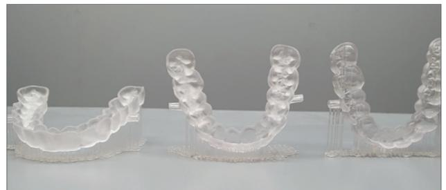
Ausrichtung der Schienen (v. l. n. r.) 20° (empfohlen), 60°, 90°
