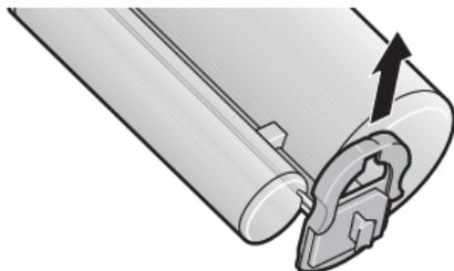
1. Para abrir o cartucho, deslizar a corredeira de bloqueio para cima. Não retirar a corredeira de bloqueio do cartucho.
