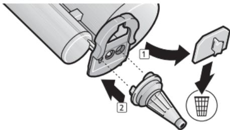
2. Снимите крышку-заглушку с картриджа и выбросьте её. Установите новый смесительный наконечник.
