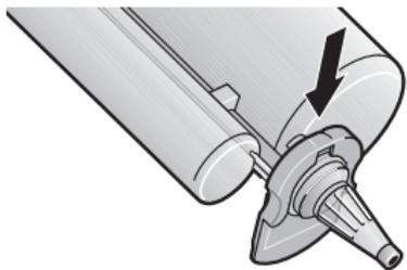
3. Зафиксируйте смесительный наконечник, закрыв задвижку.
