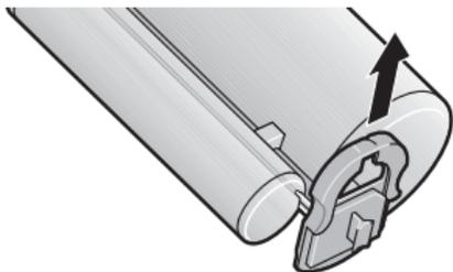
1. Aby otworzyć nabój, należy przesunąć zasuwę blokującą w górę. Nie należy zdejmować zasuwę blokującej z naboju.
