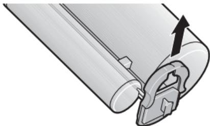
1. Para abrir el cartucho, deslice hacia arriba el mecanismo de bloqueo. No retire el mecanismo de bloqueo del cartucho.
