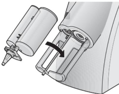
4. Kartusche in den MixStar-eMotion einsetzen. Ein kurzes akustisches Signal bestätigt das korrekte Einsetzen der Kartusche.
