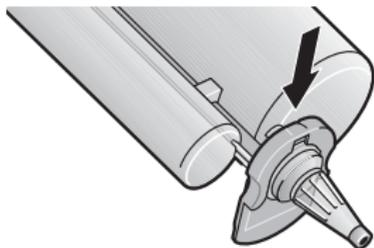
3. Mischkanüle durch Schließen des Verriegelungsschiebers arretieren.
