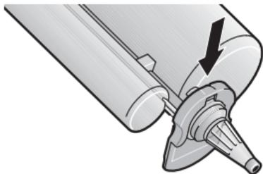
3. Bloccare la cannula di miscelazione chiudendo il dispositivo di chiusura.
