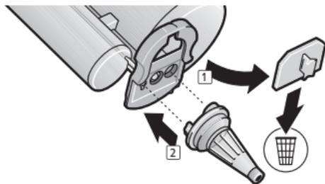
2. Retire y deseche la tapa del cartucho. Coloque una nueva cánula de mezcla.
