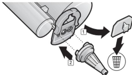
2. Den Verschluss von der Kartusche abziehen und verwerfen. Neue Mischkanüle aufsetzen.
