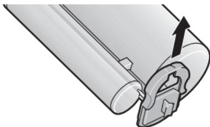
1. Zum Öffnen der Kartusche den Verriegelungsschieber nach oben schieben. Verriegelungsschieber nicht von der Kartusche abziehen.
